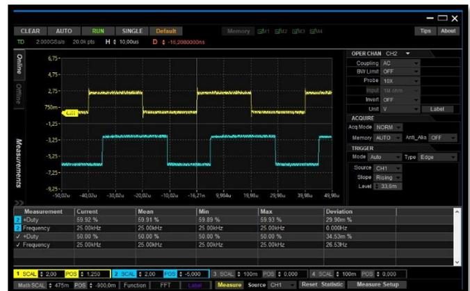
Stessa onda quadra precedente (traccia gialla) rilevata su modulo CPU (traccia azzurra) a 10KHz (sinistra) e 25KHz (destra)
