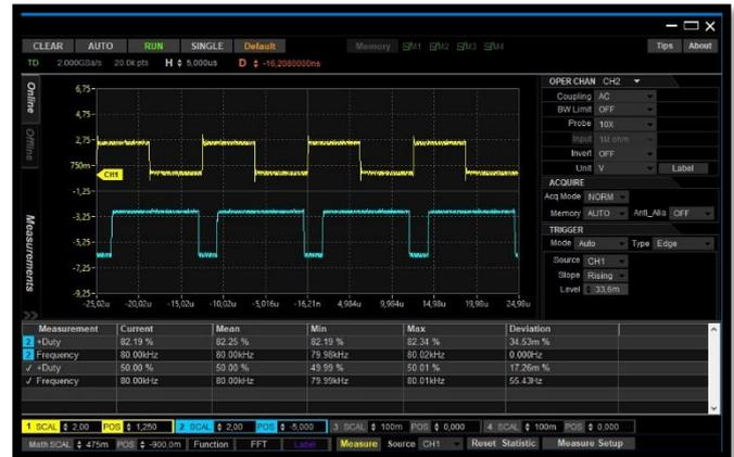
Stessa onda quadra precedente (traccia gialla) rilevato su modulo CPU (traccia azzurra) a 50kHz (sinistra) e 80kHz (destra)
