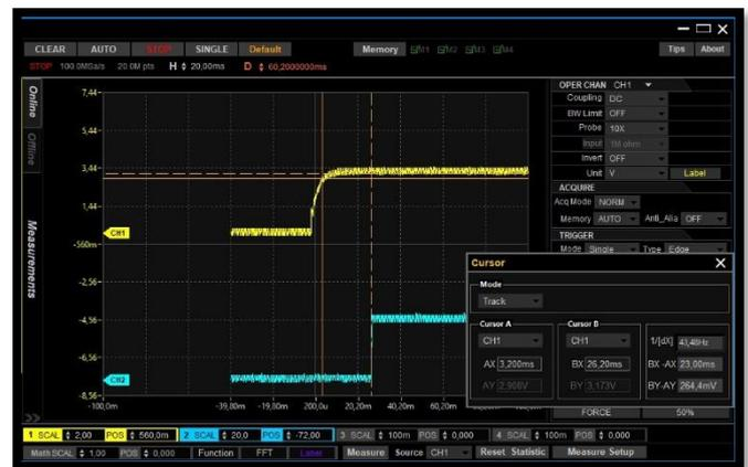
*Ritardo di attivazione del segnale di uscita (traccia azzurra) rispetto al 10% (a sinistra) e 90% (a destra) del fronte del segnale di comando (traccia gialla) con tensione di alimentazione esterna di 32V*
