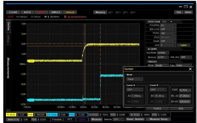
*Ritardo di attivazione del segnale di uscita (traccia azzurra) rispetto al 10% (a sinistra) e 90% (a destra) del fronte del segnale di comando (traccia gialla) con tensione di alimentazione esterna di 5V*
