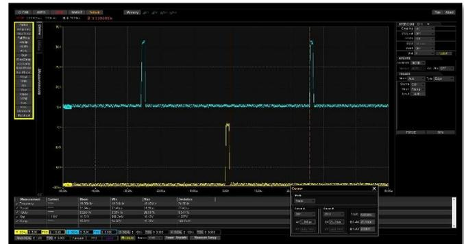
**PWM2-A (traccia gialla) e PWM2-B (traccia azzurra) a max duty-cycle (a sinistra) e a d.c.  $\approx 1\%$  (a destra)**
