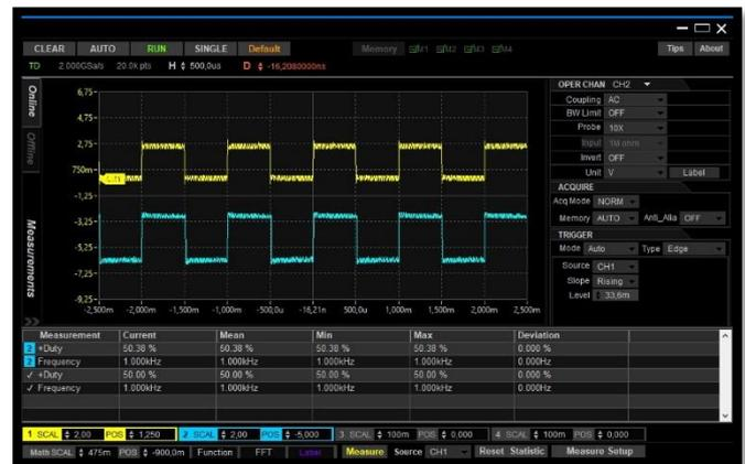
Acquisizione di un'onda quadra con d.c. 50% (traccia gialla) rilevato su modulo CPU (traccia azzurra) a 100Hz (sinistra) e 1KHz (destra)
